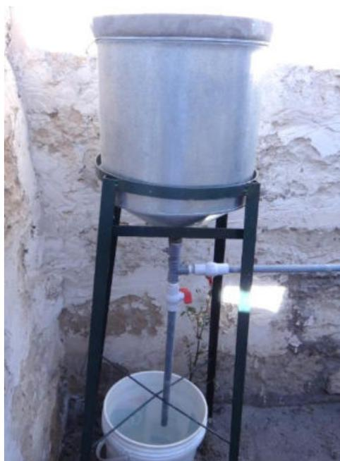
Figura 1. Proceso de sedimentación, previo al ensayo de la electrocoagulación.
