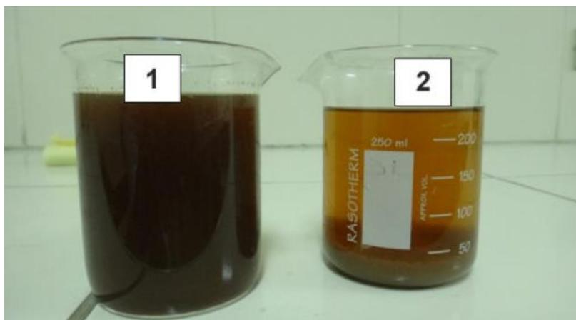
Figura 3. Muestra compuesta C; 1) antes del tratamiento con electrocoagulación, 2) después del tratamiento con electrocoagulación.
