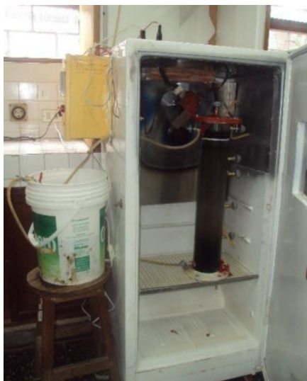
Figura 4: Puesta en marcha del reactor RAFA a 35°C
