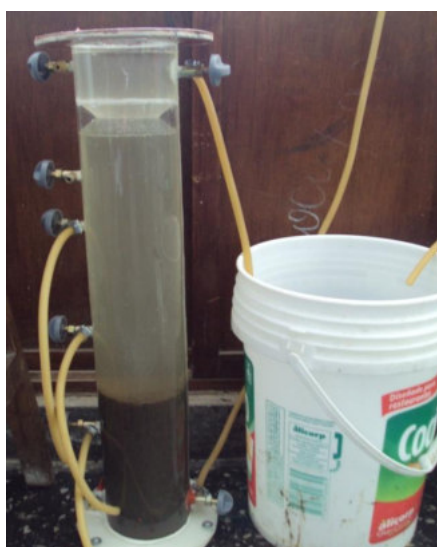
Figura 3. Puesta en marcha del reactor RAFA a temperatura ambiente
