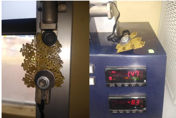
Figura 3.- Prueba de tracción y elongación del patrón mesoestructura celular para filamento METAL PLA con impresora 3D M3D Crane Quad.
