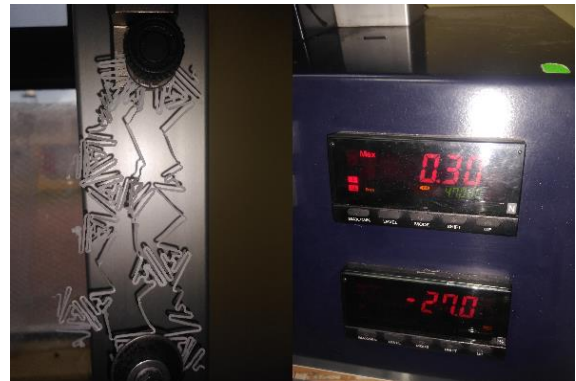
Figura 5.- Prueba de tracción y elongación del patrón mesoestructura celular para filamento HIPS con impresora 3D Anet A8.
