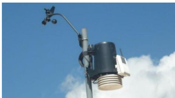
Figura 1. Estación meteorológica DAVIS INSTRUMENTS - UNA, Puno.
