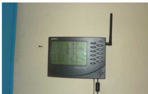
Figura 2. Consola de almacenamiento de datos - UNA, Puno.
