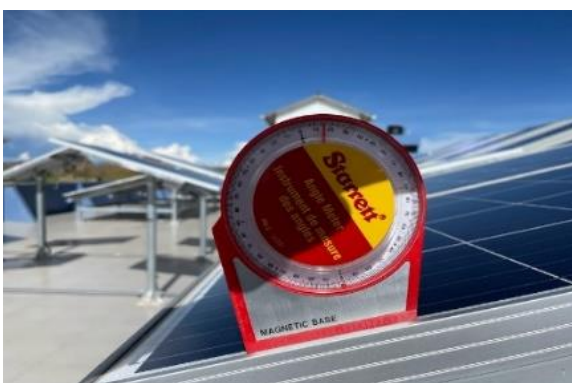
Figura 3. Ángulo de inclinación de los módulos fotovoltaicos.
