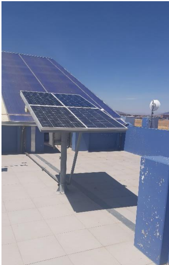
Figura 2. Módulos fotovoltaicos monocristalino y policristalino con polvo y sin polvo.
