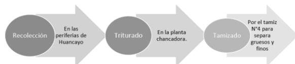
Figura 1. Diagrama de flujo del procesamiento del vidrio reciclado
